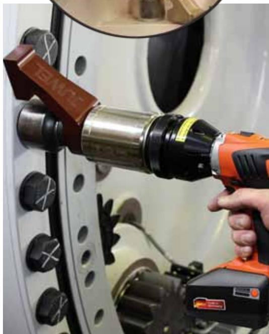
Die TQS Modellreihe deckt Drehmomente von 100 bis 4.000 Nm ab und gehört damit zu den stärksten drehmomentgenauen Werkzeugen auf dem Markt. Mit 4 Gängen sind die Geräte um ein Vielfaches schneller als vergleichbare netzbetriebene Lösungen. Dank der leistungsstarken 18 V / 5 Ah Lithium-Ionen Akkus werden selbst längere Vorgänge spielerei bewältigt. Auf Anfrage fertigen wir auch Geräte mit Drehmomenten von 5.000 Nm und mehr. |
