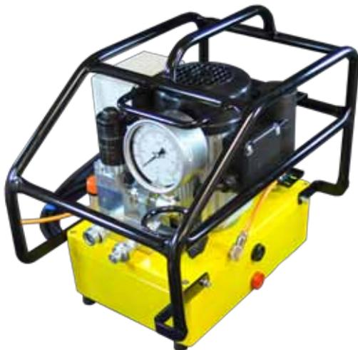
3-stufiges Elektrohydraulikaggregat zum Betrieb von hydraulischen Drehmomentwerkzeugen. Extrem kompakte Bauweise. 2-Knopf Sicherheits-Fernbedienung mit 5 Meter langem Anschlusskabel mit Stecksystem. Lieferbar für Wechselspannungen von 100-230 Volt, 50/60 Hz mit einem Maximaldruck bis 800 bar (wahlweise 700 bar). Einfache und genaue Druck- bzw. Drehmomenteinstellung.
