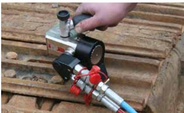
Der 360° schwenkbare Drehanschluss erleichtert die Positionierung an schwer zugänglichen Stellen. Einfaches Tauschen der Antriebsteile und Wechselkassetten durch Drucktaste. Zum Umstecken sind keine Werkzeuge erforderlich. |
