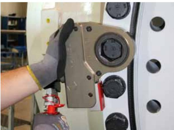
Hydraulisch angetriebene Drehmomentschrauber sind das ideale Werkzeug. Kompaktes, hochfestes Design sowie geringes Gewicht und kleine Kopfradien zeichnen unsere Geräte aus. Die konstante Drehmomentleistung bietet äußerste Präzision über den vollen Hub und eine hohe Wiederholgenauigkeit von  $\pm 2,5\%$ . |
