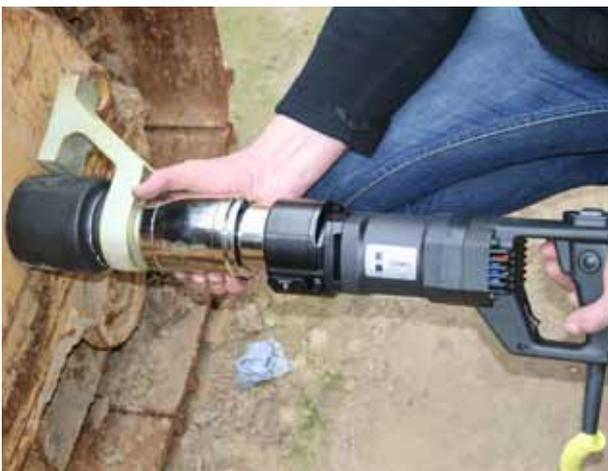
JUWEL-Elektro-Kraftschrauber aus der Standard Baureihe TES, TEWS und TESM sind sehr kompakte Elektro-Kraftschrauber, die aufgrund ihrer Robustheit und Zuverlässigkeit weltweit hoch geschätzt werden. Die Geräte finden überall dort Verwendung, wo hohe Anzieh- und Lösemomente aufgebracht werden müssen. |
